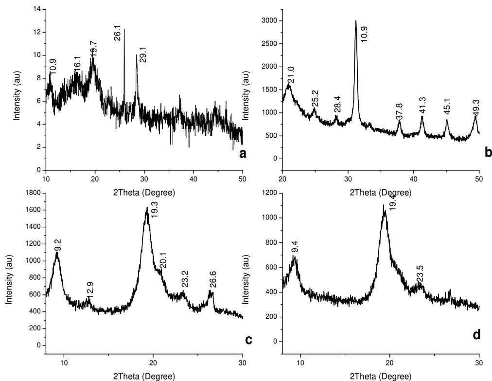
Figure 7: X- Ray patterns of (a) prawn shell (b) shrimp shell (c) prawn chitin and (d) shrimp
